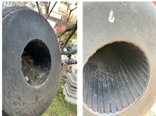
(左) 1824年に製造された大砲 (右)1890年に製造された大砲。内部の凸凹により砲弾にジャイロ回転がかかり、弾道が安定する。
