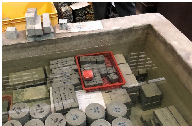
図 5-6.5 水に浮くコンクリート (中央の赤い立方体)
