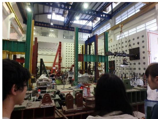
破砕装置と次に使う試験体の建設の様子
