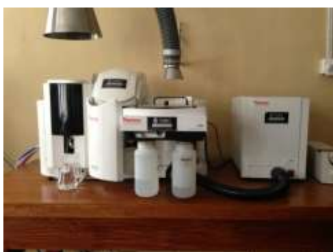
溶液中の金属イオンないし金属原子を ppm~ppb オーダーで検出する装置
