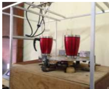
粒子の表面積を測定する装置 (こちらも手作り)
